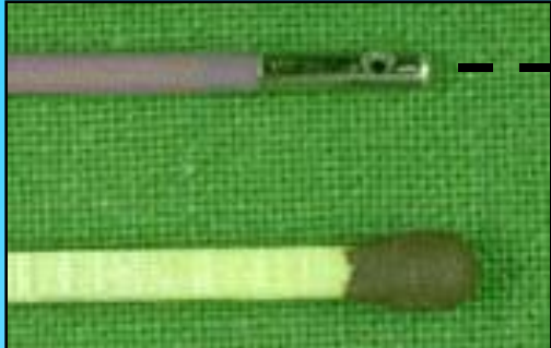
Die Kanüle mit dem Drucksensor
